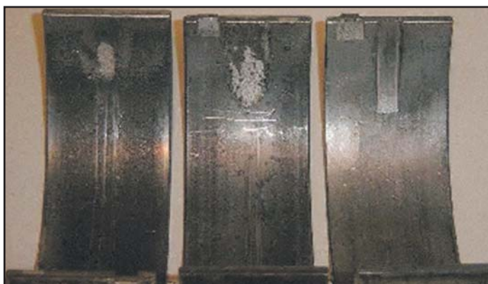
Fotografía de tres casquillos de cojinetes que se instalaron a nuevo en un motor reconstruido y extraídas después de 300.000 millas. Observe el daño por erosión en los dos cojinetes sin alivio (izquierda) en comparación con el cojinete IPD (derecha) con caja de alivio de presión.
